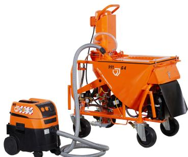
Рис. 50: Система пылеудаления
