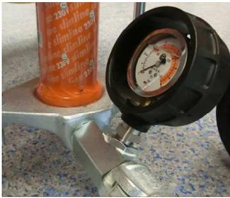
Рис. 48: Манометр давления раствора
