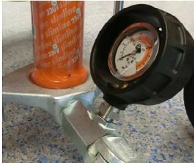
Рис. 30: Манометр давления раствора
