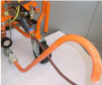
Рис. 54: Труба для контроля консистенции раствора
