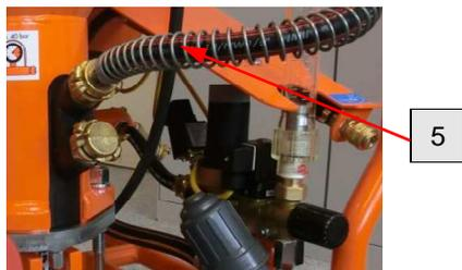
Рис. 41: Отсоединение водяного шланга
