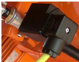
Рис. 113: Мембранный выключатель по воздуху
