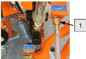
1. Подключите шланг для сжатого воздуха (1) к пневматической арматуре.
