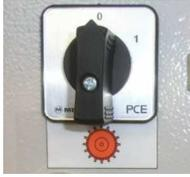
Рис. 87: Выключение подающего барабана
