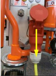
Рис. 108: Удаление соединительного кабеля
