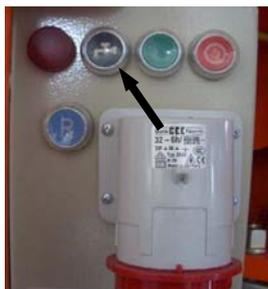
Wasservorlauftaste drücken. Das Wasser wird nun mit Druckluft aus der Armatur geblasen! (bei 1,5bar ca. 1 Minute lang)
