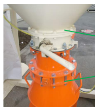
Рис. 14: Присоединение бадьи
