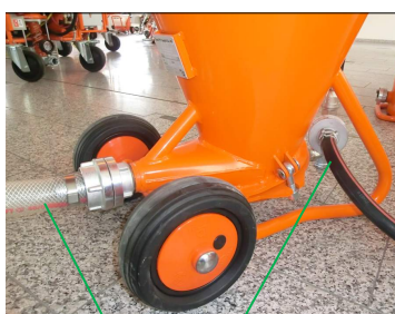
Рис. 15: Присоединение подающего рукава
