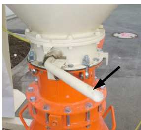
Рис. 33: Закрытие выпускной заслонки хранилища
