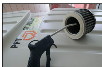
Рис. 51: Очистка фильтрующих патронов
