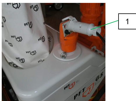
Рис. 37: Отсоединение управляющего штекера
