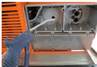
Рис. 51: Очистка фильтрующих патронов
