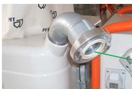
Рис. 15: Присоединение подающего рукава
