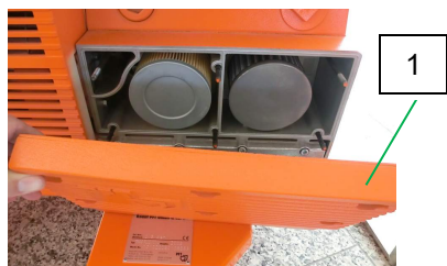
Рис. 49: Крышка фильтра
