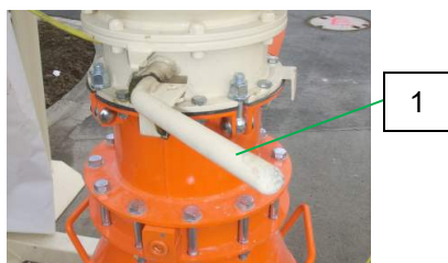
Рис. 40: Закрытие выпускной заслонки хранилища
