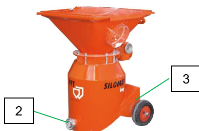
Рис. 18: Присоединение рукавов
