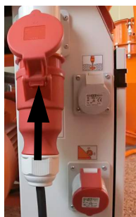
Рис. 13: Подключение электропитания
