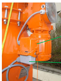
Рис. 21: Присоединение управляющего кабеля
