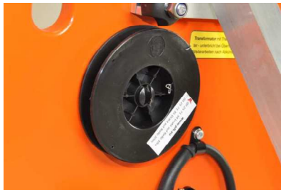
Fig. 35: Fio de corte de substituição
