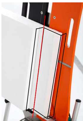
Fig. 5: Corte por sobreposição
