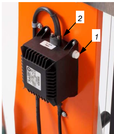
Fig. 34: Transformador
