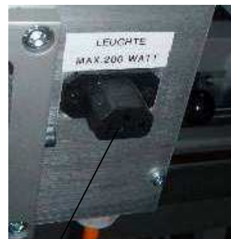
Tomada para ferramentas – na parte traseira da máquina máx. 200 W
