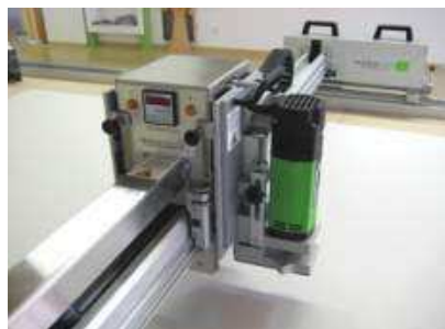
Imagem 11.01 Cabeçote de fresado direita
