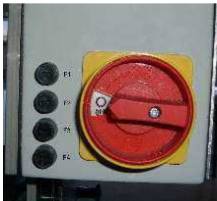
Interruptor principal 0-1 com mecanismo de disparo de tensão mínima.
