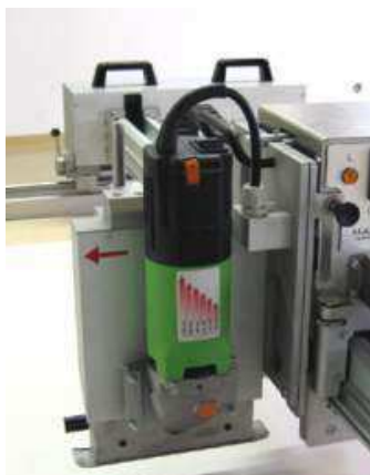
Imagem 15.02 cabeçote de serra - longitudinal
