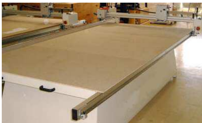
A máquina com os painéis de DM colocados e aparafusados.
