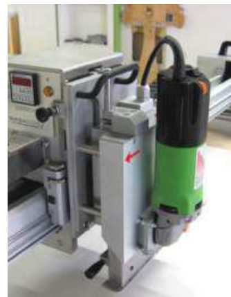
Imagem 15.03 cabeçote de serra - transversal
