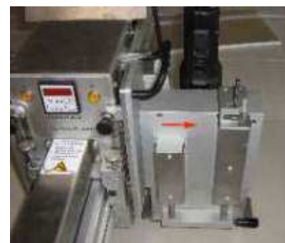
Imagem 11.07 Cab. Corte cinco folhas - longitudinalmente
