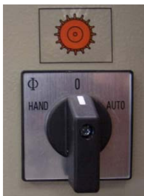
Fig. 11: Modos de funcionamento da roda celular
