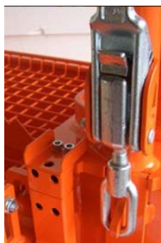
Fig. 38: Fechar o flange basculante do motor
