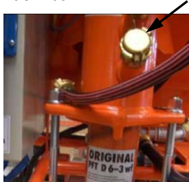
Fig. 42: Tampa cega no bocal de água
