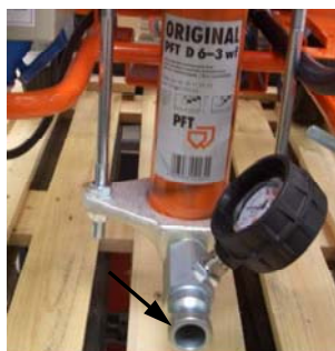
Fig. 44: Resíduos no flange de pressão
