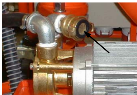
Fig. 58: Filtro de latão na entrada de água
