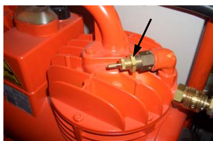
Fig. 64: Válvula de segurança
