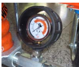
Fig. 53: Manómetro da argamassa
