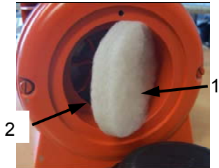
Fig. 59: Filtro do compressor
