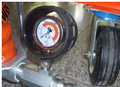
Fig. 36: Pressão da argamassa a 0
