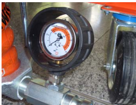
Fig. 22: Manómetro da argamassa
