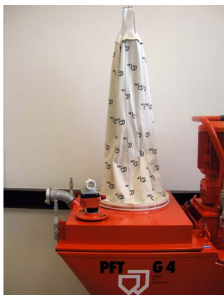
Fig. 25: Cobertura de sopro
