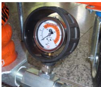
Fig. 56: Pressão da argamassa em 0
