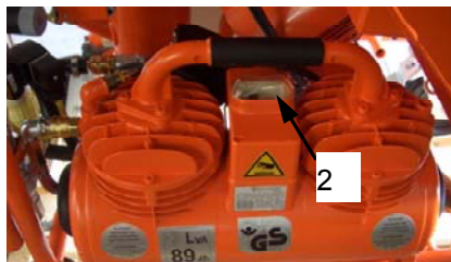
Fig. 35: Desligar compressor
