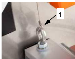
Rys. 37: Mocowanie drutu u dołu
