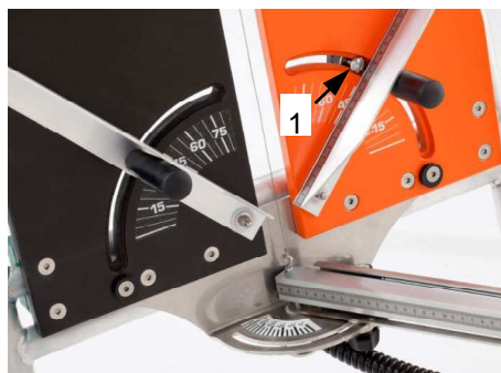
Rys. 27: Śruba ustalająca
