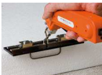
Rys. 15: Adapter do cięć profilowych
