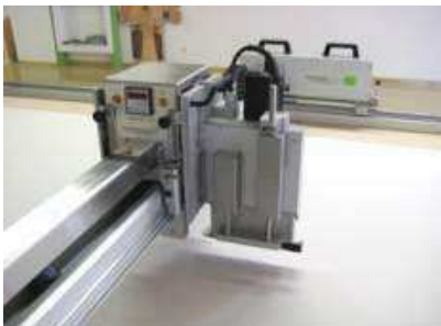
Rys. 11.03 Zespół pilarki wzdłużny - w prawo
