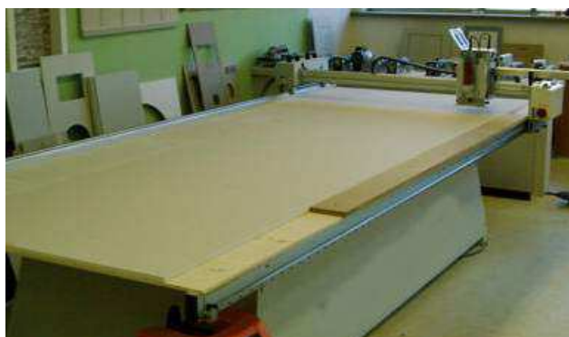
Maszyna z nałożonymi na gotowo płytami roboczymi wzgl. gipsowo-kartonowymi.
