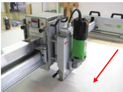
Rys. 11.05 Zespół pilarki poprzeczny - w prawo
