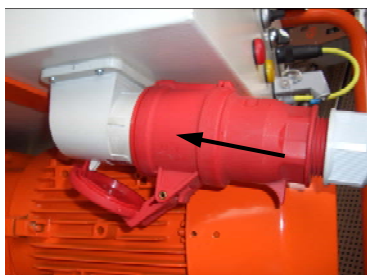
Rys. 19: Podłączenie zasilania
