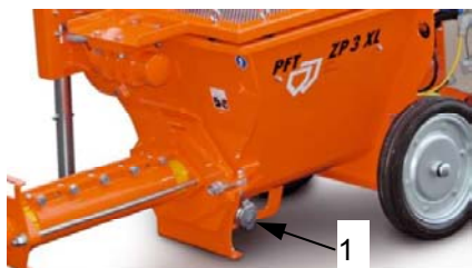
Rys. 44 Otworzyć pokrywę rewizyjną
