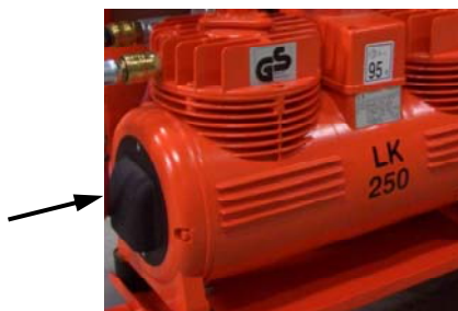
Rys. 50: Wymiana wkładu filtra
