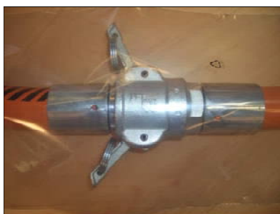
Rys. 41: Zatory węży
