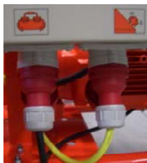
Rys. 20: Podłączenie wibratora i sprężarki powietrznej
