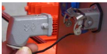
Rys. 15: Nasadzenie wtyki blokującej
