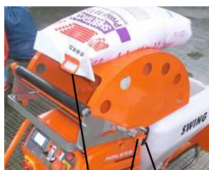
Rys. 29: Przyrząd do opróżniania worków
