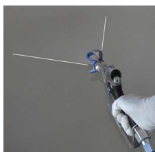
Rys. 45: „Obraz” natryskiwania
