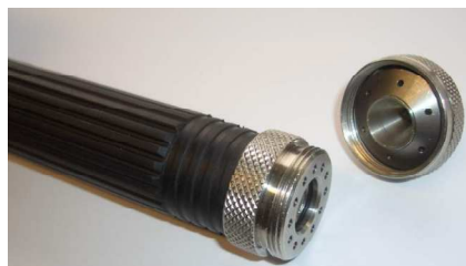
Rys. 26: Odkręcić dyszę
