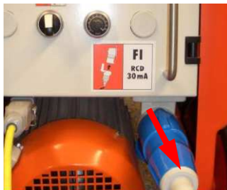
Rys. 42: Usunąć przewód przyłączeniowy
