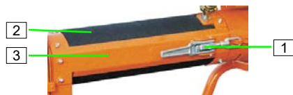
ilustracja 46: Czyszczenie rury mieszalnej
