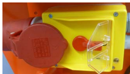
ilustracja 39: Mechanizm do przestawiania sekwencji faz w położeniu „0”
