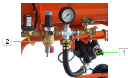
ilustracja 24: Sita osadnika zanieczyszczeń z pompą podnoszenia ciśnienia
