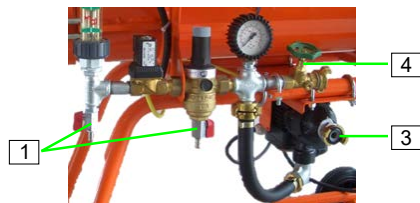
ilustracja 26: Przyłącze zasilania wodą z pompą podnoszenia ciśnienia
