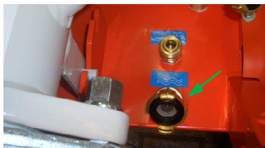
Rys. 80: Sitko osadnika zanieczyszczeń w punkcie dopływu wody
