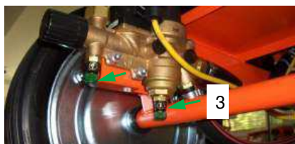
Rys. 68: Otworzyć kurek spustowy
