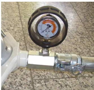
Rys. 39: manometr ciśnienia zaprawy
