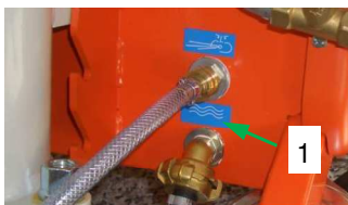
Rys. 44: Podłączenie węża powietrza
