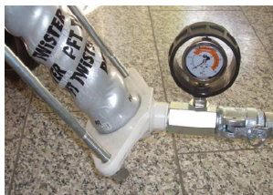
Rys. 73: Manometr ciśnienia zaprawy
