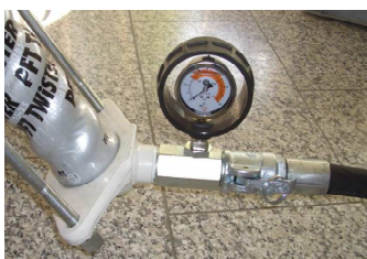
Rys. 76: Ciśnienie zaprawy na „0” bar.
