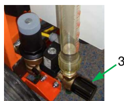
Rys. 82: Zawór redukcyjny
