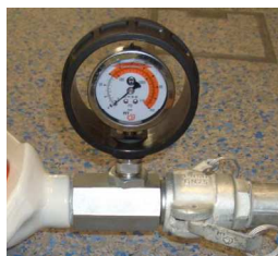
Rys. 23: Manometr ciśnienia zaprawy
