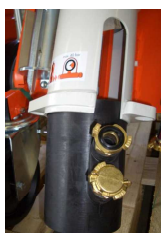
Rys. 63: Czyszczenie gumowej strefy ochronnej
