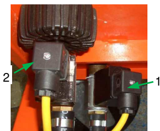
Rys. 83: Wyłącznik ciśnieniowy
