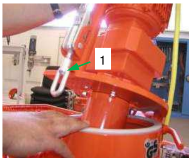
Rys. 60: Zamykanie uchylnego kołnierza silnika
