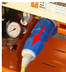
Rys. 111: Odłączenie przewodu przyłączeniowego
