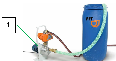
Rys. 42: Pompa wspomagająca
