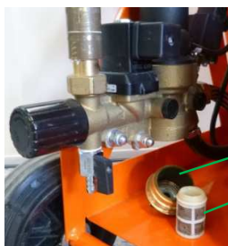
Rys. 114: Sitko wychwytywacza zanieczyszczeń
