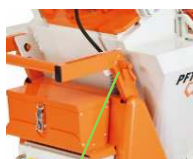
Rys. 32: Otwieranie rygli obrotowych
