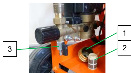
Rys. 39: Sito osadnika zanieczyszczeń
