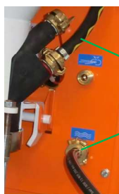
Rys. 109: Podłączenie węża powietrznego
