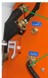
Rys. 106: Odłączanie dopływu wody
