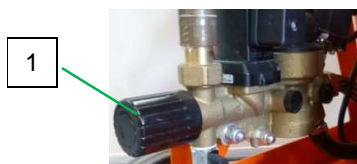
Rys. 115: Reduktor ciśnienia
