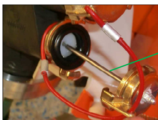
Rys. 112: Dysza w rurze mieszania
