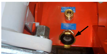
Rys. 112: Sito wychwytywacza zanieczyszczeń w dopływie wody
