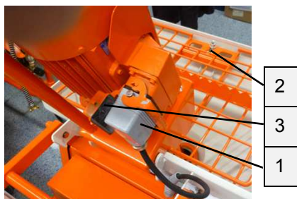
Rys. 91: Otwieranie kołnierza uchylnego silnika
