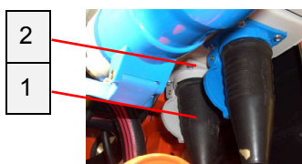
Rys. 59: Podłączenie wibratora
