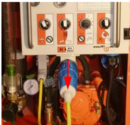
Rys. 111: Odłączenie i usunięcie przewodu zasilania
