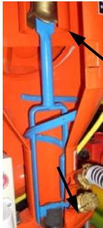
Rys. 39: Zamknąć kołnierz uchylny silnika
