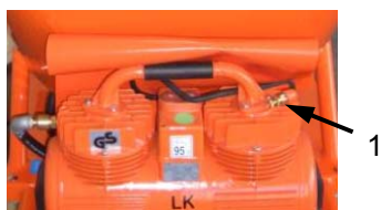
Rys. 66: Zawór bezpieczeństwa
