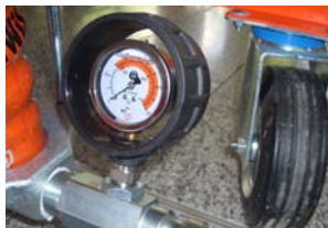
Rys. 54: Manometr ciśnienia zaprawy
