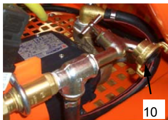
Rys. 27: Przygotowanie węża do zaprawy
