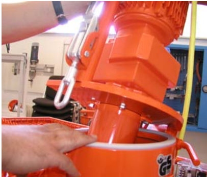
Rys. 38: Zamknąć kołnierz uchylny silnika
