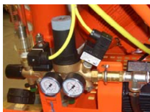
Rys. 18: Sitko osadnika zanieczyszczeń
