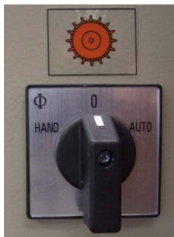
Rys. 11: Tryby robocze koła dozownika
