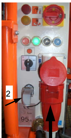
Rys. 16: Podłączenie zasilania
