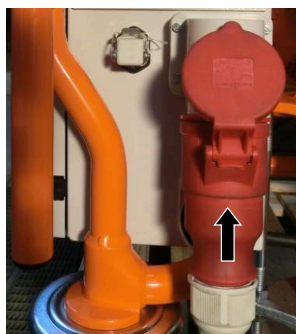
ilustracja 29: Podłączenie zasilania elektrycznego
