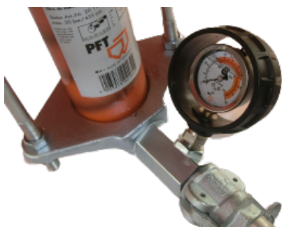
ilustracja 26: Manometr ciśnienia zaprawy
