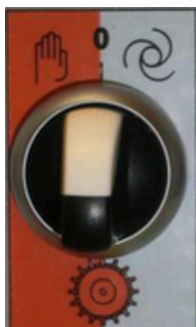
ilustracja 18: Przełącznik wirnika łopatkowego
