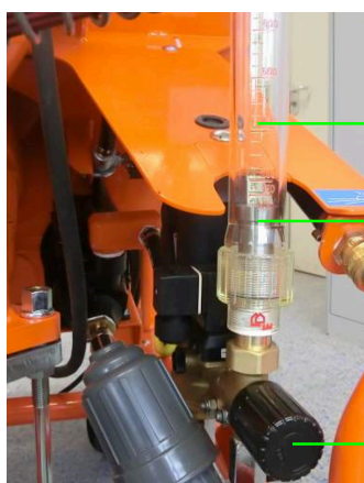
ilustracja 37: Regulacja natężenia przepływu wody
