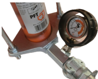
ilustracja 16: Manometr ciśnienia zaprawy
