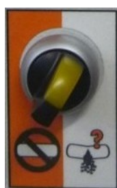
ilustracja 20: Przełącznik wybierający sondy poziomu napełnienia
