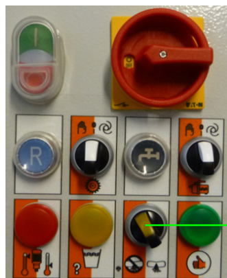
ilustracja 66: Dezaktywacja sondy poziomego napełnienia
