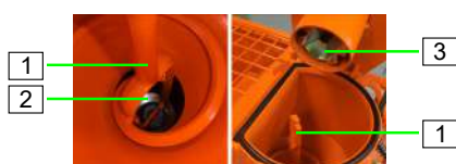
ilustracja 80: Wkładanie mieszadła
