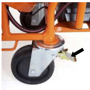
ilustracja 29: Blokada rolki ustalającej
