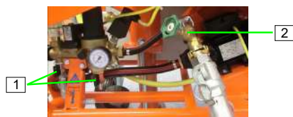
ilustracja 32: Zamknięcie zaworów spustowych
