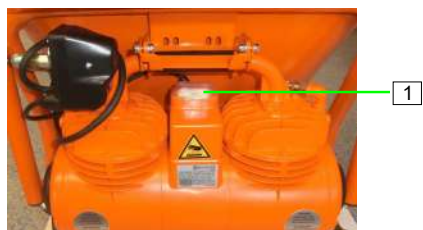
ilustracja 46: Włączanie sprężarki powietrza
