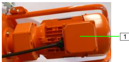
ilustracja 25: Wyłącznik nachylenia
