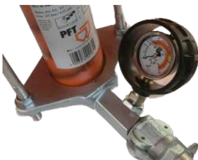
ilustracja 17: Manometr ciśnienia zaprawy
