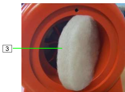
ilustracja 88: Filtr sprężarki powietrza
