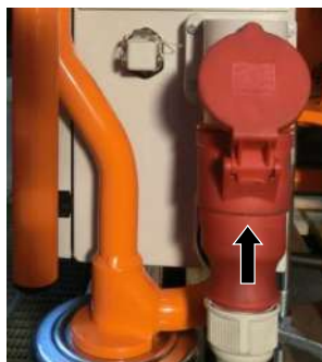
ilustracja 30: Podłączenie zasilania elektrycznego
