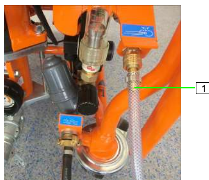
ilustracja 44: Podłączanie węża sprężonego powietrza
