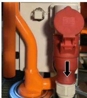
ilustracja 86: Odłączanie kabla zasilającego
