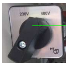
ilustracja 21: Zmiana napięcia
