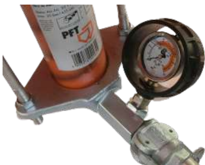
ilustracja 27: Manometr ciśnienia zaprawy
