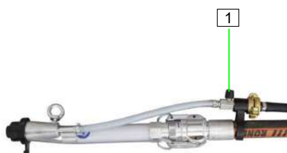
ilustracja 64: Zamykanie kurka sprężonego powietrza
