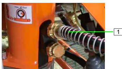
ilustracja 79: Podłączanie węża wody
