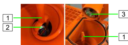
ilustracja 84: Wkładanie mieszadła
