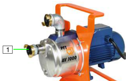
ilustracja 54: Zalewanie pompy
