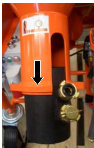
ilustracja 87: Czyszczenie gumowej strefy mieszalnej
