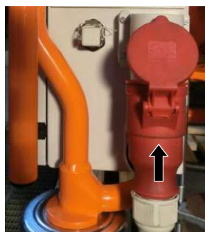
ilustracja 34: Podłączenie zasilania elektrycznego
