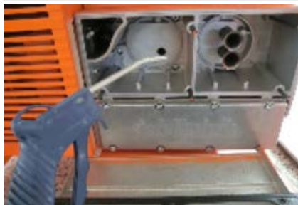
ilustracja 62: Czyszczenie obudowy filtra
