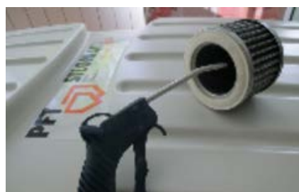
ilustracja 61: Czyszczenie wkładów filtra
