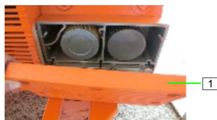
ilustracja 59: Odlączanie pokrywy filtra
