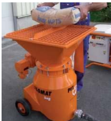
ilustracja 23: Napełnianie materiałem w workach
