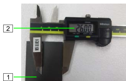
ilustracja 53: Kontrola szerokości zasuw
