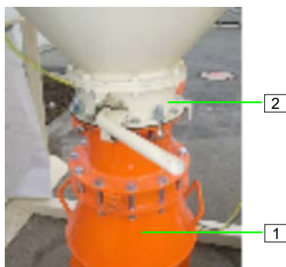
ilustracja 18: Podłączanie pojemnika transportowego
