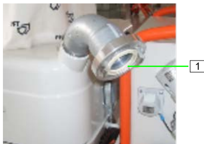
ilustracja 19: Podłączanie węża tłoczego
