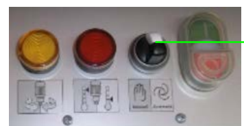
ilustracja 42: Przedmuchiwanie węży tłocznych
