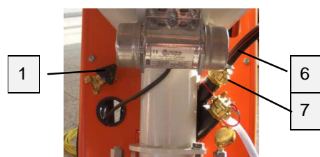
Afb. 34: Wateraftapklep
