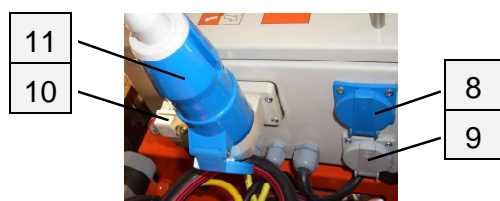
Abb. 10: Anschlüsse Schaltschrank
