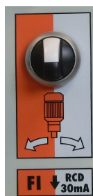
Afb. 1: Bedrijfsschakelaar pompmotor
