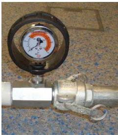
Afb. 36: Morteldrukmanometer
