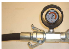
Afb. 75: Morteldrukmanometer
