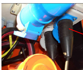
Afb. 45: Luchtcompressor inschakelen
