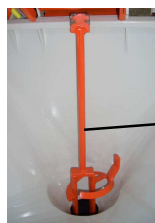
Afb. 60: Mengspiraal verwijderen
