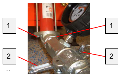
Afb. 77: Trekanker losmaken
