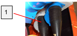
Afb. 46: Trilmachine aansluiten
