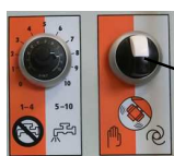
Afb. 47: Trilmachine inschakelen
