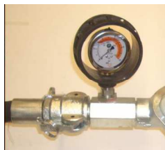
Afb. 22: Morteldrukmanometer
