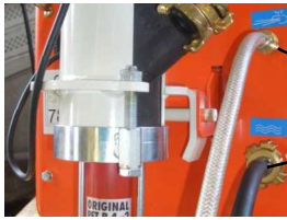
Afb. 108: Luchtslang aansluiten
