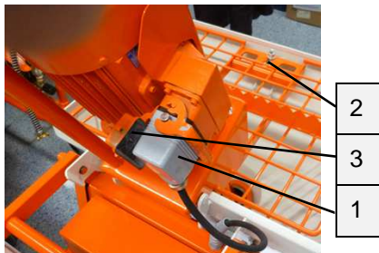
Afb. 91: Motorkantelflens openen
