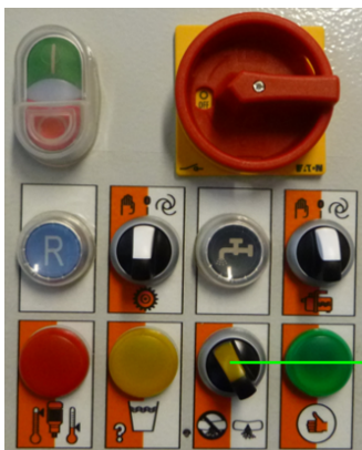
Afbeelding 66: Niveausonde uitschakelen
