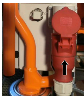
Afbeelding 29: Stroomvoorziening aansluiten
