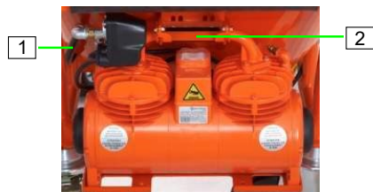
Afbeelding 83: Luchtcompressor verwijderen
