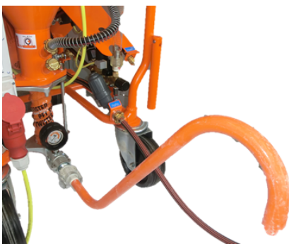
Afbeelding 48: Consistentiecontrolebuis
