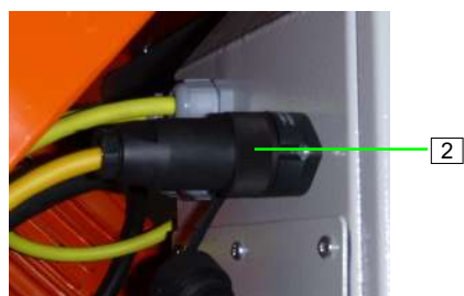
Afbeelding 28: Niveausonde uitschakelen
