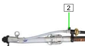
Afbeelding 62: Luchtkraan openen
