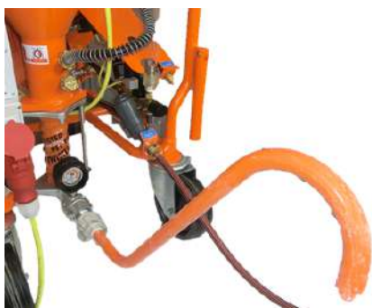
Afbeelding 57: Consistentiecontrolebuis
