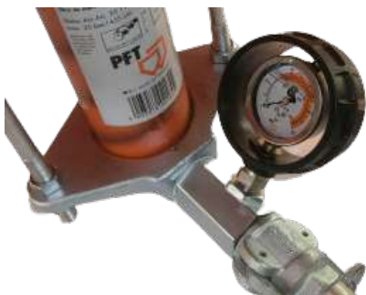
Afbeelding 29: Morteldrukmanometer
