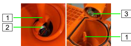
Afbeelding 85: Mengspiraal inzetten
