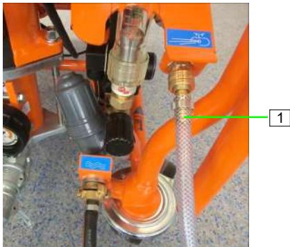
Afbeelding 48: Luchtslang aansluiten
