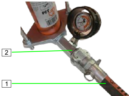
Afbeelding 46: Mortelslang aansluiten
