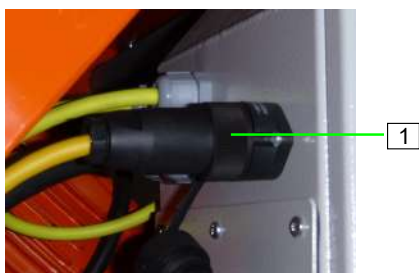
Afbeelding 75: Niveausonde uitschakelen
