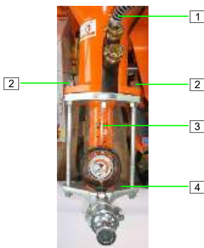
Afbeelding 86: Pompeenheid afnemen
