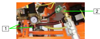
Afbeelding 36: Aftapkraan sluiten
