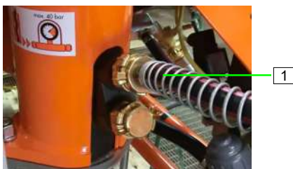
Afbeelding 79: Waterslang aansluiten
