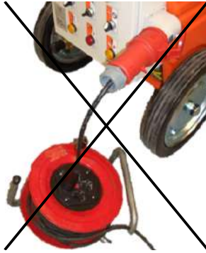
Afbeelding 33: Voorbeeldafbeelding voor een niet-toegestane aansluitvariant
