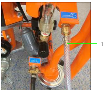
Afbeelding 48: Lucht slang aansluiten
