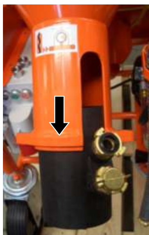
Afbeelding 87: Rubbermengzone reinigen
