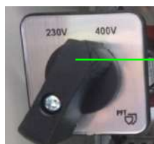
Afbeelding 21: Spanning wijzigen
