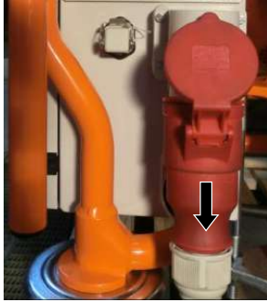
Afbeelding 95: Aansluitkabel verwijderen
