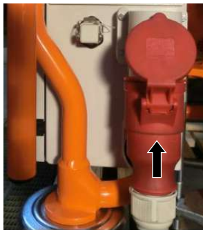
Afbeelding 34: Stroomvoorziening aansluiten
