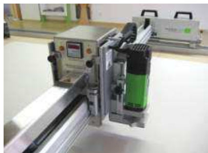
Slika 11.01 agregat za glodanje desno
