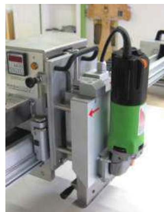
Slika 15.03 Rezni agregat - poprečno
