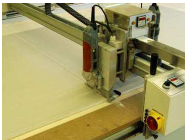
Poprečni rezni agregat na razinu prešanih ploča od iverice.
