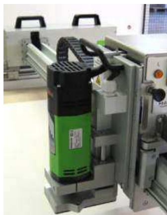
Slika 15.01 Agregat za glodanje
