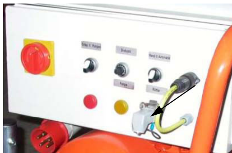
Slika 12: Namjestiti slijepi utikač
