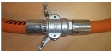
Slika 31: Razdvajanje spojeva
