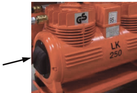
Slika 53: Izmjena filtera
