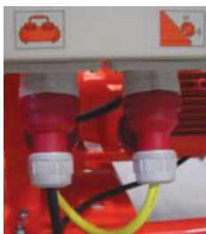
Slika 21: Priključiti vibrator i kompresor za zrak
