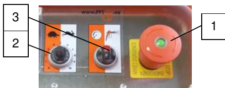
Sl. 41: Sklopka za odabir načina rada motora pumpe
