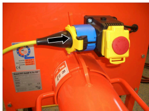
slika 22: Priključivanje napajanja
