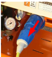
Sl. 111: Uklanjanje priključnog kabela
