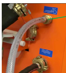
Sl. 60: Priključivanje crijeva za zrak
