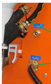
Sl. 109: Priključiti crijevo zraka
