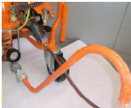
Slika 50 Cijev za provjeru gustoće žbuke
