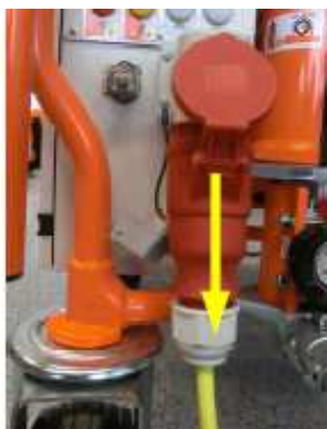
Slika 97 Uklonite konekcijske kablove
