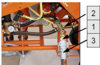
Slika 54 Priprema crijeva za žbuku
