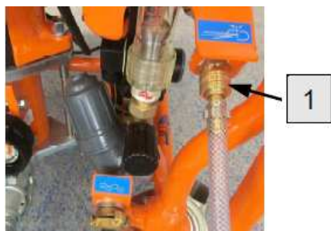
Slika 57 Spajanje crijeva za zrak
