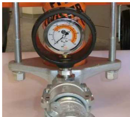
Slika 27 Mjerač za pritisak žbuke
