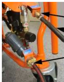
Slika 95 Sušenje priključka za vodu zrakom
