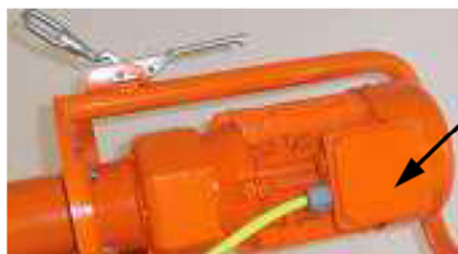
Slika 31 Nagibni prekidač
