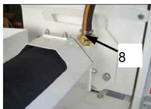
Fig. 27: Collegare il tubo flessibile dell'acqua (8) al tubo di miscelazione
