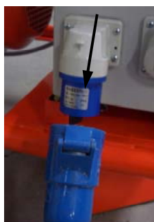
Fig. 57: Staccare il cavo di alimentazione
