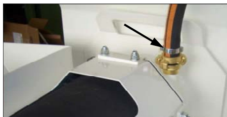
Fig. 55: Staccare il tubo flessibile dell'acqua dal tubo di miscelazione
