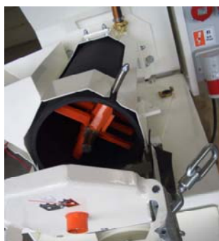
Fig. 48: Pulire il tubo di miscelazione
