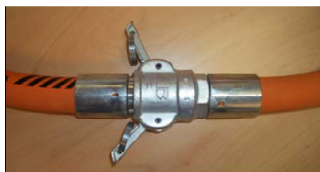
Fig. 46: Allentare le connessioni
