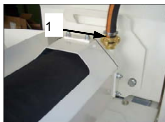
Fig. 22: Staccare il tubo flessibile dell'acqua
