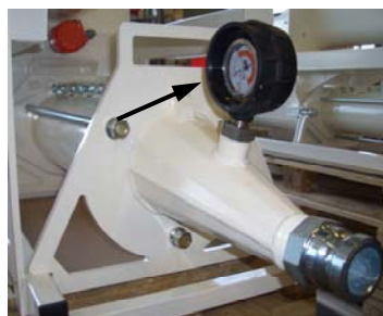
Fig. 20: Manometro per pressione malta
