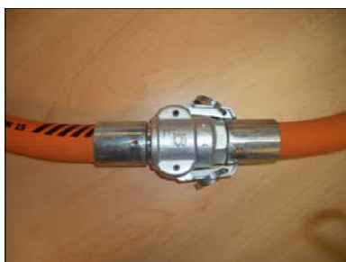
Fig. 31: Giunti di accoppiamento puliti
