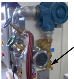
Fig. 54: Staccare il tubo flessibile dell'acqua
