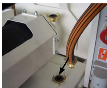
Fig. 51: Pulire la tramoggia della pompa
