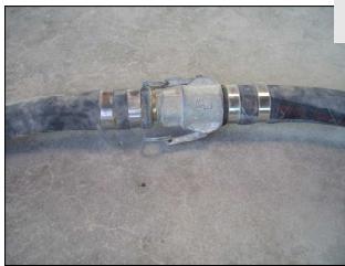
Fig. 51: Distacco del giunto
