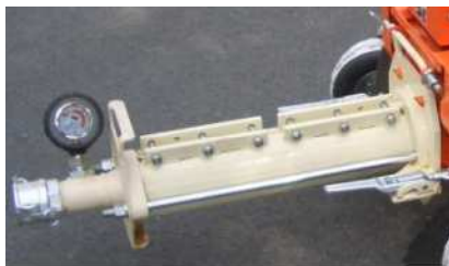
Fig. 77: Cambiare la pompa
