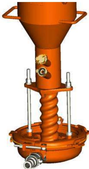
Fig. 18: Rotoquirl con flangia di aspirazione saldata
