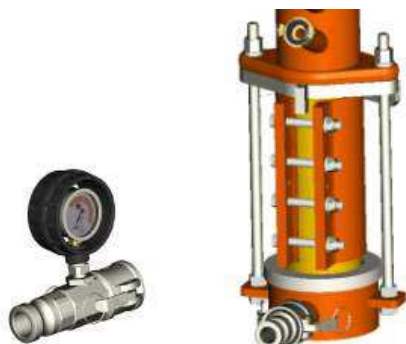
Fig. 37: Montaggio del miscelatore e del manometro di pressione della malta
