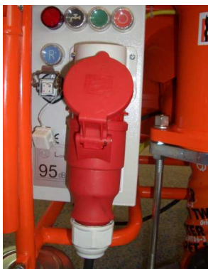
Fig. 30: Scollegare la presa della corrente
