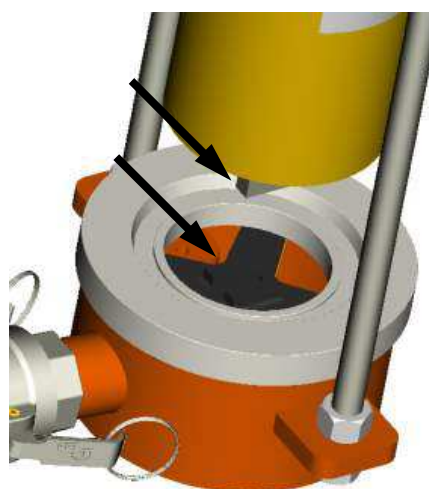
Fig. 26: Dente del rotore nell'aletta di miscelazione Rotomix
