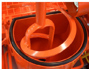
Fig. 38: Montaggio della pala impastatrice
