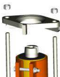
Fig. 36: Montaggio della flangia di aspirazione
