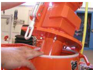
Fig. 32: Pericolo di schiacciamento flangia di ribaltamento del motore
