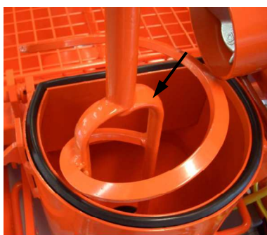
Fig. 34: Rimozione della pala impastatrice
