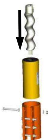
Fig. 31: Montaggio della pompa
