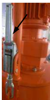
Fig. 33: Apertura della flangia di ribaltamento del motore
