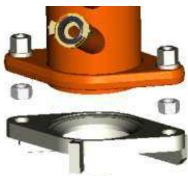
Fig. 35: Smontaggio della flangia di aspirazione
