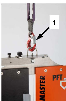
Fig. 13: Spostamento con gru
