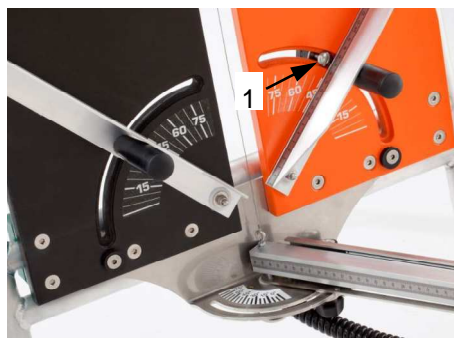
Fig. 18: Vite di registro
