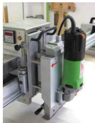
Figura 15.03 Unità di taglio trasversale
