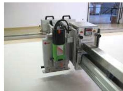
Figura 11.04 Unità di taglio longitudinale a sinistra
