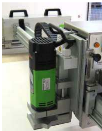
Figura 15.01 Unità di fresatura
