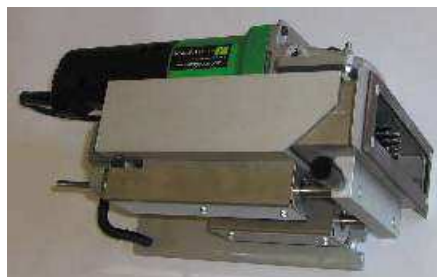
Figura 15.03N Sega a 5 lame
