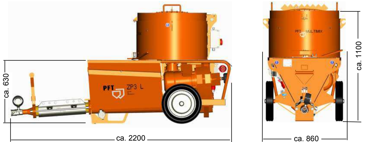
Fig. 2: Disegno quotato PFT ZP 3 L MULTIMIX
