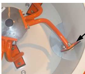
Fig. 78: Regolazione del braccio miscelatore
