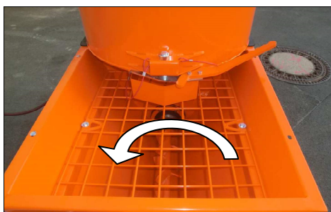
Fig. 31: Controllo del senso di rotazione
