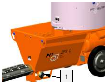
Fig. 67: Apertura del coperchio di pulizia
