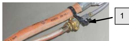
Fig. 55: Chiusura del rubinetto dell'aria
