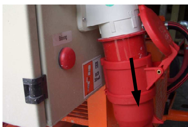
Fig. 76: Rimozione del cavo di alimentazione
