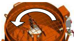
Fig. 25: Controllare il senso di rotazione
