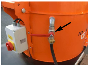
Fig. 28: Collegamento dell'acqua
