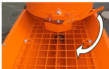
Fig. 44: Svuotamento della MULTIMIX
