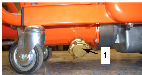
Fig. 42: Apertura del coperchio di pulizia
