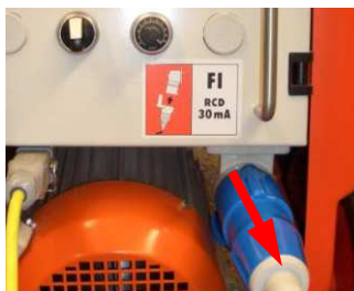
Fig. 50: Rimozione del cavo di collegamento
