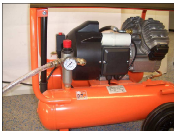
Fig. 30: Collegamento del tubo flessibile per aria
