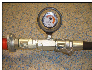
Fig. 51: Pressione della malta su "0 bar".
