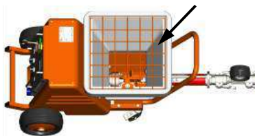
Fig. 27: Riempimento di materiale
