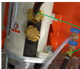
Fig. 94: Scollegamento dell'alimentazione dell'acqua
