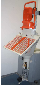
Fig. 34: Unità pompa impastatrice
