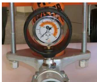
Fig. 49: Manometro per pressione malta
