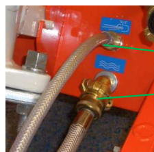
Fig. 97: Allacciamento del tubo flessibile dell'aria
