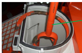
Fig. 95: Estrazione del miscelatore
