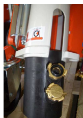
Fig. 91: Pulizia dell'area di miscelazione in gomma
