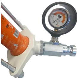
Fig. 31: Manometro per pressione malta
