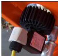
Fig. 103: Pressostato
