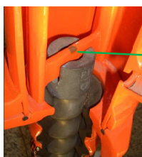
Fig. 92: Sede rotore
