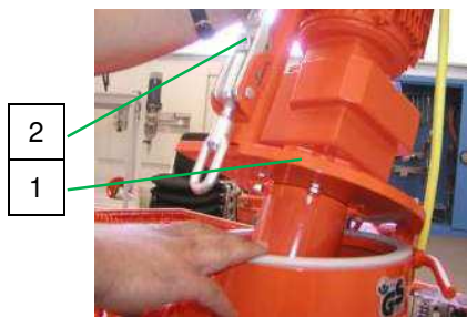
Fig. 88: Chiusura della flangia del motore
