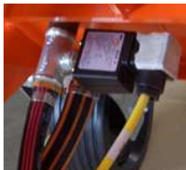
Fig. 104: Pressostato
