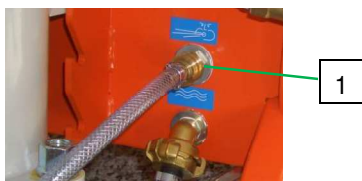
Fig. 61: Collegamento del flessibile per aria
