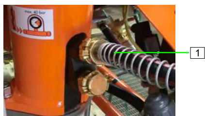
Figura 74: Collegamento del tubo dell'acqua
