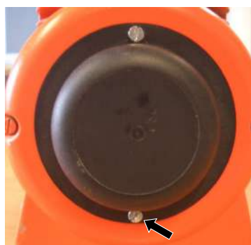
Figura 88: Apertura della copertura del filtro
