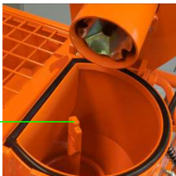
Figura 75: Apertura della flangia ribaltabile del motore
