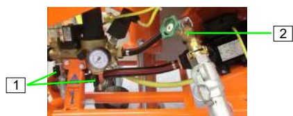
Figura 31: Chiudere i rubinetti di scarico
