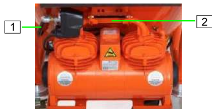
Figura 86: Rimuovere il compressore aria
