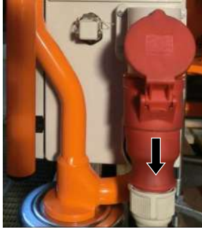
Figura 85: Rimozione del cavo di collegamento
