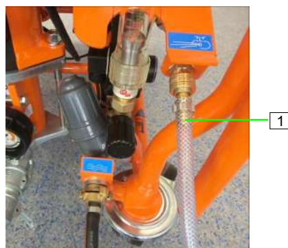
Figura 43: Collegare il tubo flessibile per aria
