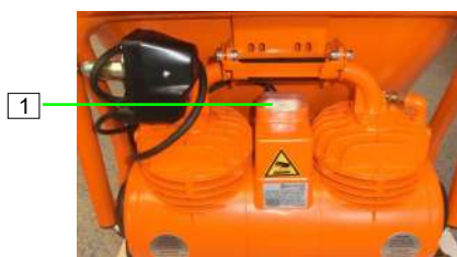
Figura 61: Spegner il compressore aria
