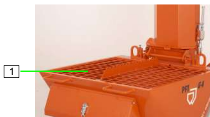
Figura 27: Copertura a griglia
