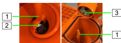
Figura 79: Inserimento della pala di miscelazione
