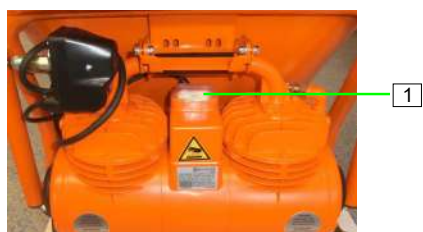
Figura 45: Accendere il compressore aria
