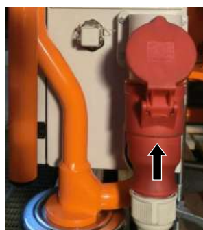
Figura 30: Collegamento all'alimentazione elettrica
