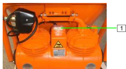
Figura 46: Accendere il compressore aria
