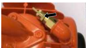
Figura 94: Valvola di sicurezza
