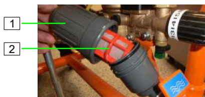
Figura 90: Filtro in plastica
