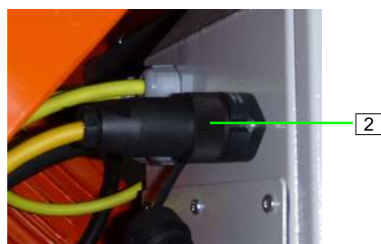
Figura 28: Disattivare la sonda di livello
