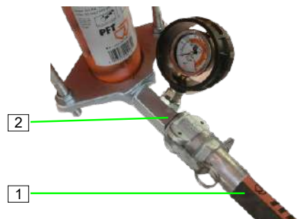
Figura 46: Collegare il tubo malta
