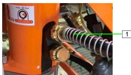
Figura 80: Collegamento del tubo dell'acqua
