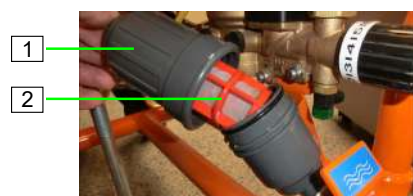
Figura 93: Filtro in plastica
