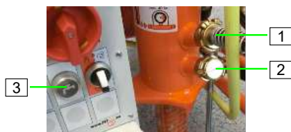
Figura 44: Immettere acqua nella zona di miscelazione
