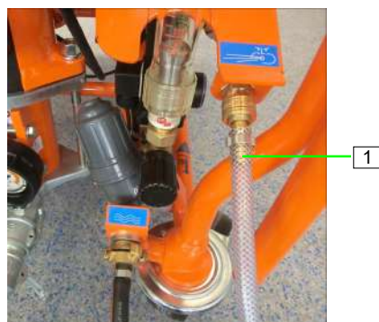
Figura 48: Collegare il tubo flessibile per aria
