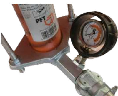
Figura 29: Manometro provamateriale
