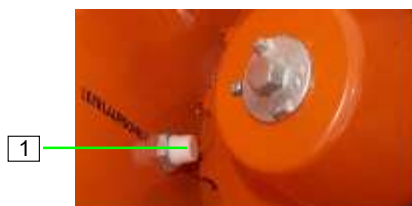
Figura 27: Sonda di livello nella tramoggia materiale
