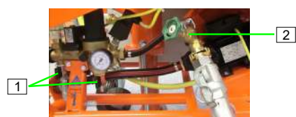
Figura 37: Chiudere i rubinetti di scarico
