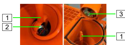
Figura 85: Inserimento della pala di miscelazione
