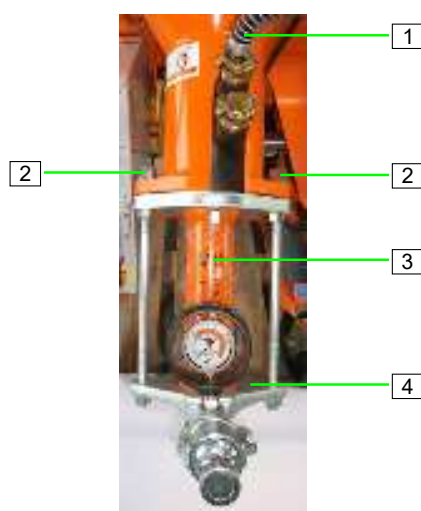
Figura 86: Rimozione del gruppo pompa
