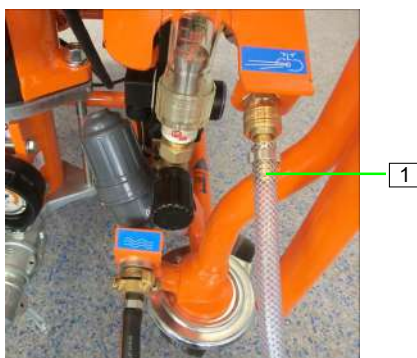
Figura 48: Collegare il tubo flessibile per aria
