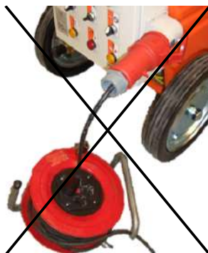
Figura 33: Figura esemplificativa: variante di collegamento non ammessa
