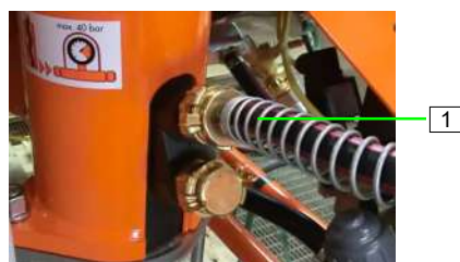
Figura 79: Collegamento del tubo dell'acqua
