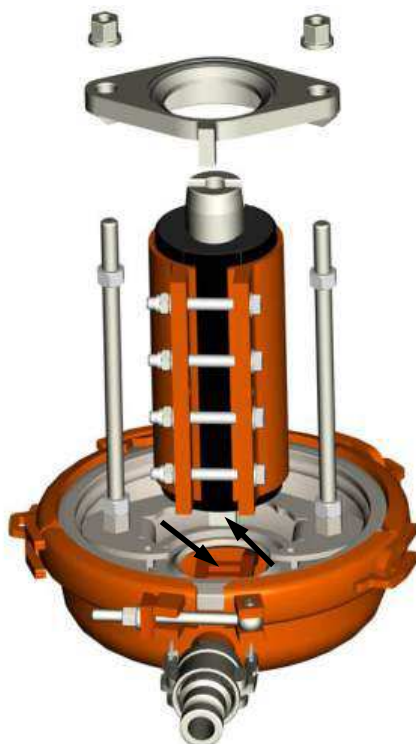
Illustration 28 : Installer le système de pompe (les broches du rotor prises dans la lame de mélange).
