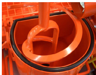
Illustration 38 : Monter l'arbre de malaxage
