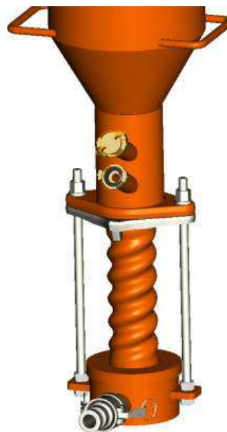
Illustration 21 : Rotoquirl avec bride d'aspiration remplaçable
