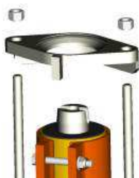
Illustration 36 : Démonter la bride d'aspiration
