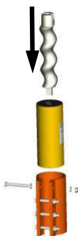
Illustration 31 : Assembler la pompe
