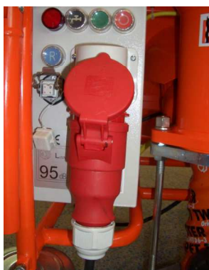
Illustration 30 : Couper le branchement électrique
