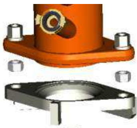
Illustration 35 : Démonter la bride d'aspiration
