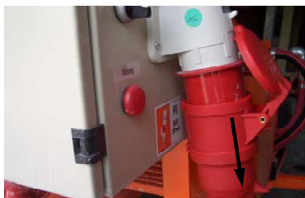
Fig. 53: Enlever le câble de raccordement
