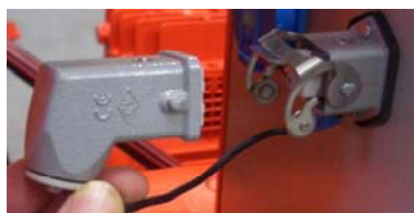
Fig. 19 : Enficher la fiche isolante
