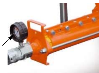
Fig. 41 : Pression du mortier « 0 bar »
