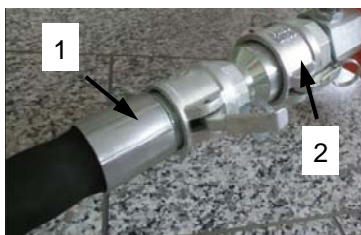
Fig. 28 : Raccorder le tuyau à mortier
