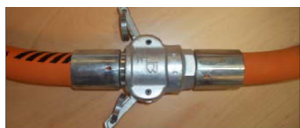
Fig. 46: Démontant les raccords
