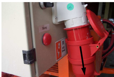
Illustration 76 : Retrait du câble de raccordement
