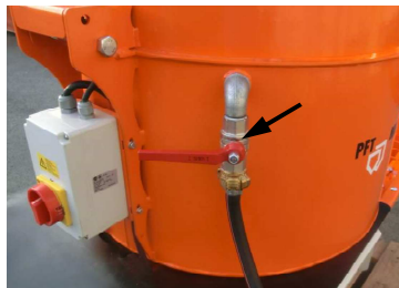
Illustration 28 : Raccordement d'eau
