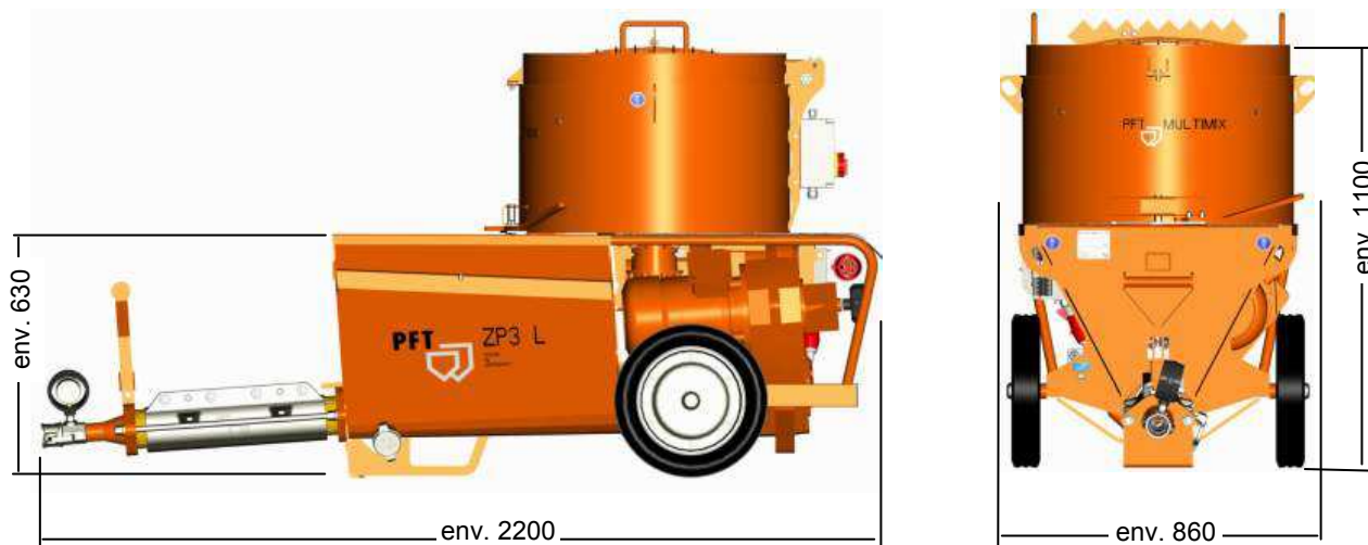
Illustration 2: Schéma coté PFT ZP 3 L MULTIMIX
