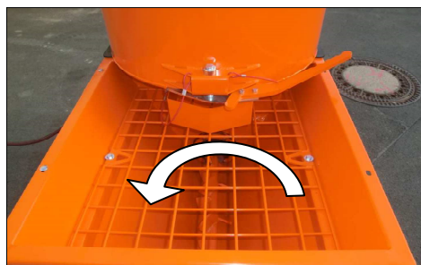
Illustration 31 : Contrôle du sens de rotation
