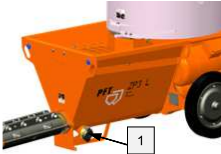
Illustration 67 : Ouverture du couvercle de nettoyage
