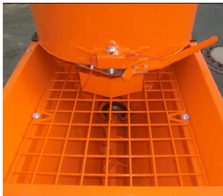
Illustration 50 : Verser le matériau dans le réservoir
