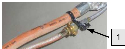
Illustration 52 : Ouverture du robinet d'air
