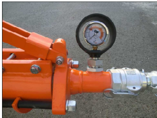
Illustration 19 : Manomètre de pression du mortier
