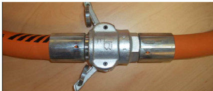
Illustration 69 : Déconnexion de raccords
