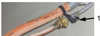
Illustration 55 : Fermeture du robinet d'air
