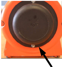
Illustration 82 : Orifice couvercle du filtre
