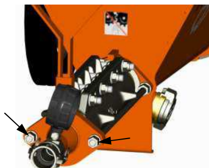
Illustration 71 : Dévissage des écrous
