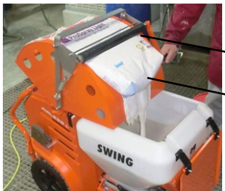
Illustration 30 : Vidage du sac de matériau
