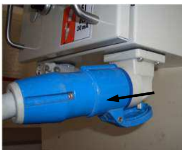
Illustration 42 : Retirer le câble de raccordement
