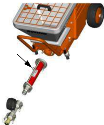
Illustration 43 : Desserrer les écrous
